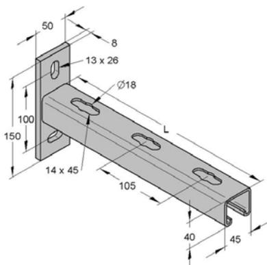
**Fertigkonsole Platte längs**
